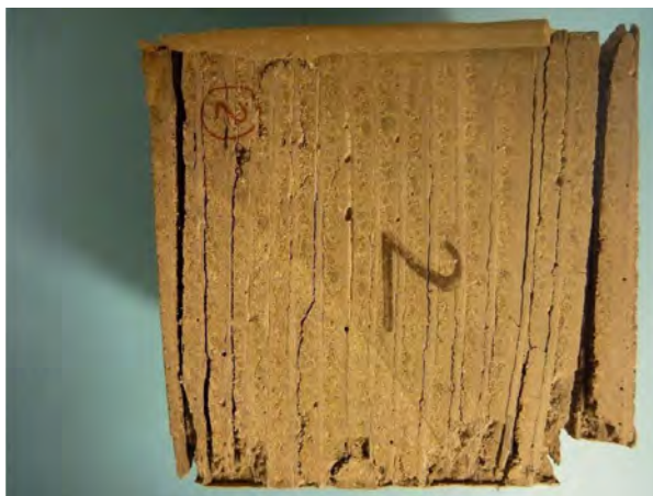
Figur 8: Brud ved tryk parallelt på fibre
