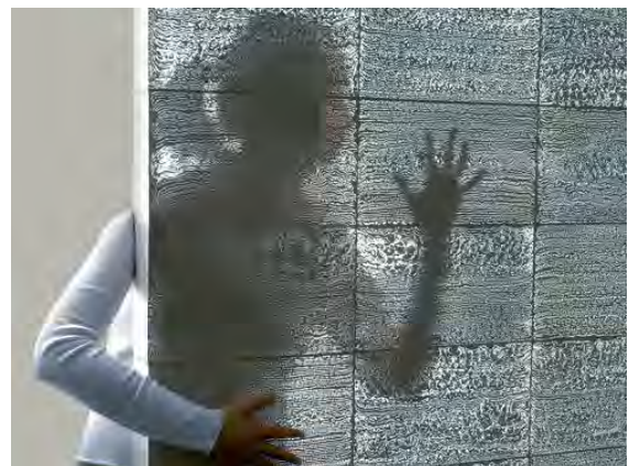
Figur 4: Illustration af gennemskinneligheden.
