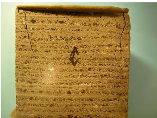
Figur 7: Brud ved tryk vinkelret på fibre
